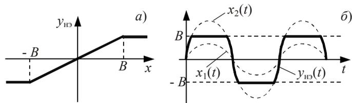
**Рис. 10.3** Зависимость частотных характеристик от амплитуды входного сигнала:
