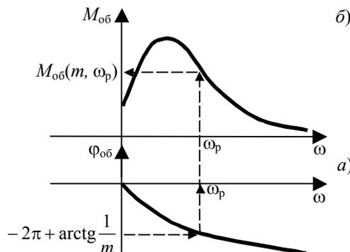
РИС. 7.16 ОПРЕДЕЛЕНИЕ НАСТРОЙКИ И-РЕГУЛЯТОРА, ОБЕСПЕЧИВАЮЩЕЙ
