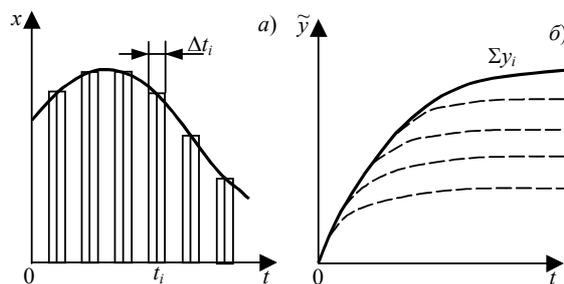
**Рис. 3.12** Представление входного (а) и выходного сигналов (б)
