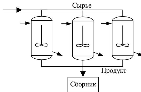
**Рис. 5.30 Пример технологического объекта параллельного соединения**
