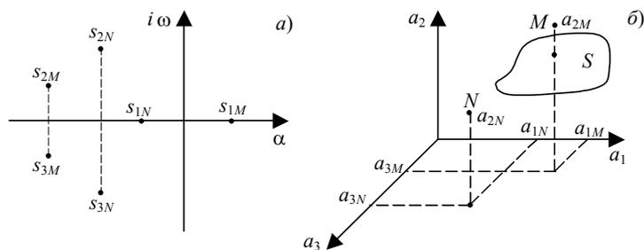
**Рис. 6.41** Связь корней характеристического уравнения и пространства коэффициентов:
