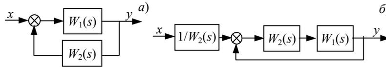
**Рис. 5.46 Вынесение элемента из обратной связи:**
