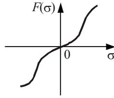
**Рис. 12.6 Характеристика нелинейного исполнительного устройства**
