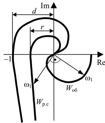
Рис. 7.5 Графическое определение предельного значения настройки И-регулятора
