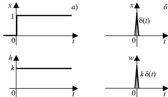
**Рис. 5.2** Графики временных характеристик усилительного звена:
