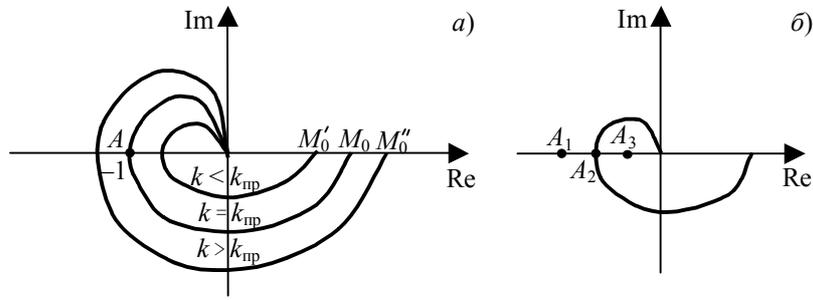
**Рис. 6.37 АФХ статической системы третьего порядка:**
