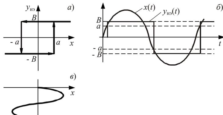
**Рис. 10.7** Двухпозиционное реле с зоной возврата:
