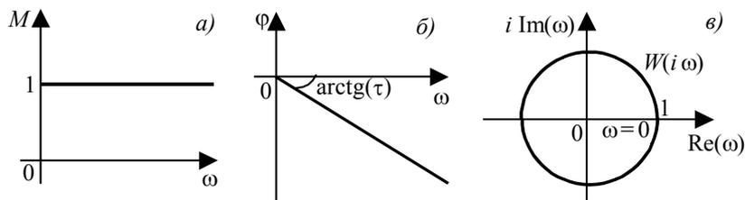
**Рис. 5.12 Частотные характеристики звена чистого запаздывания:**
