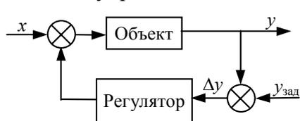
Рис. 1.6 Схема регулятора по отклонению
