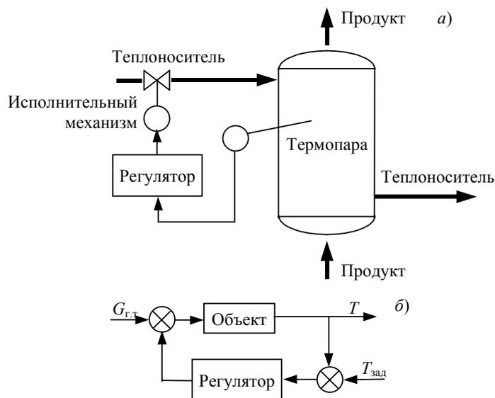
Рис. 1.9 Система регулирования температуры продукта в теплообменнике:
