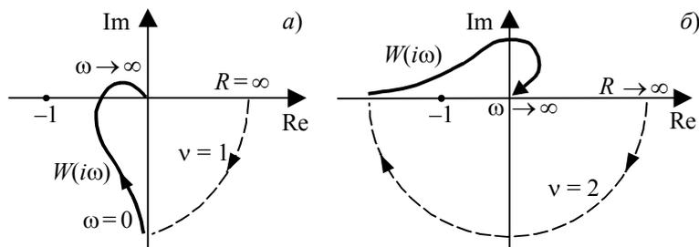
**Рис. 6.31** АФХ нейтральной разомкнутой системы:
