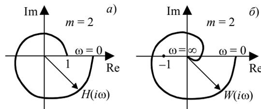
**Рис. 6.28** АФХ:  $a - H(i\omega)$ ;  $b - W(i\omega)$  при  $m = 2$
