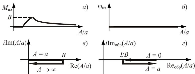
**Рис. 10.14** Эквивалентные частотные характеристики двухпозиционного реле с зоной нечувствительности: а – АЧХ; б – ФЧХ; в – АФХ; г – инверсная АФХ
