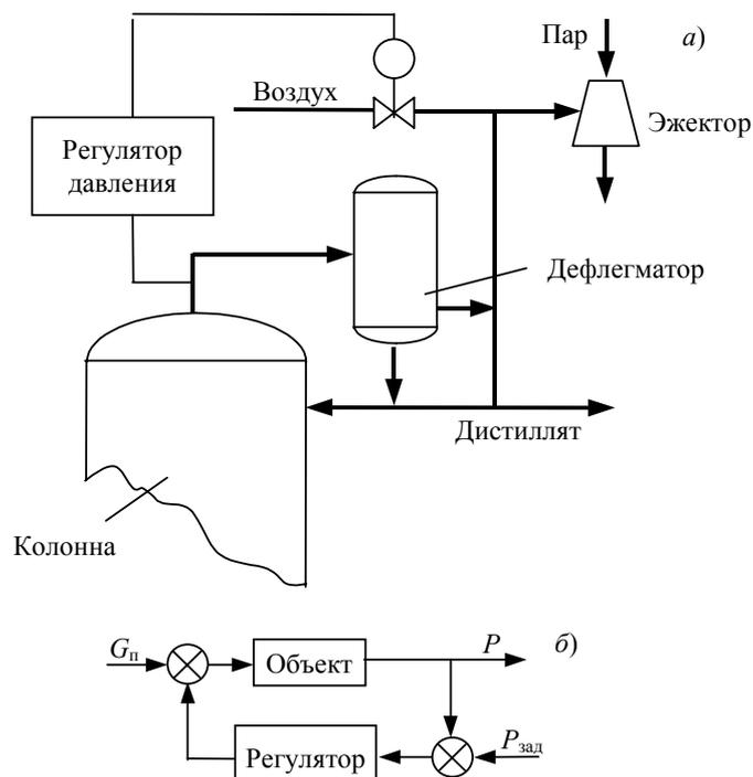
**Рис. 1.10 Система регулирования давления в верхней части колонны:**
