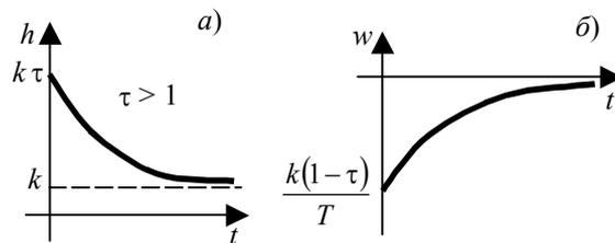
**Рис. 5.18 Переходные характеристики инерционно-форсирующего звена для  $\tau > 1$ :**
