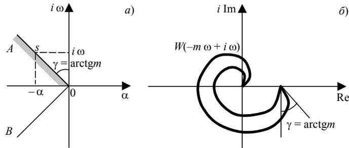
Рис. 7.12 Расширенная частотная характеристика по степени колебательности:
