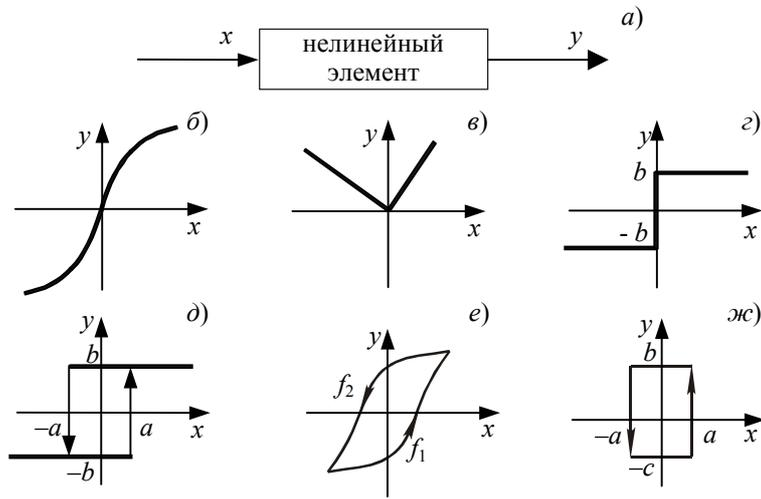
**Рис. 10.1** Статические характеристики нелинейных элементов:
