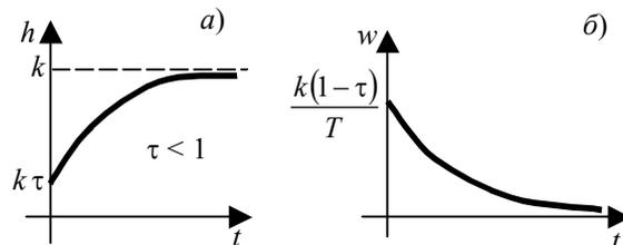
**Рис. 5.19 Переходные характеристики инерционно-форсирующего звена для  $\tau < 1$ :**
