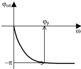
**Рис. 7.2** Определение частоты для границы устойчивости системы
