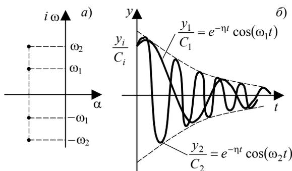
Рис. 8.6 Определение качества колебательных переходных процессов по степени устойчивости:
