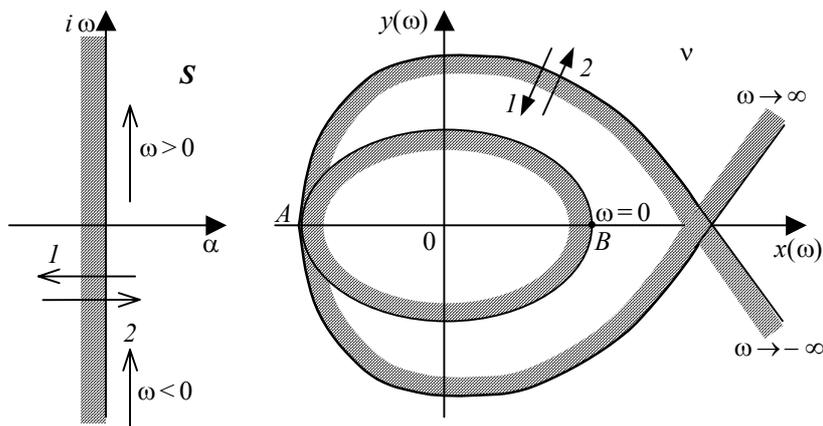
Рис. 6.43 Д-разбиение по одному параметру
