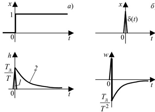
**Рис. 5.8** Переходные характеристики реального дифференцирующего звена:
