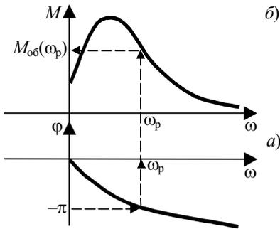
РИС. 7.15 ОПРЕДЕЛЕНИЕ НАСТРОЙКИ П-РЕГУЛЯТОРА, ОБЕСПЕЧИВАЮЩЕЙ ЗАДАННУЮ СТЕПЕНЬ КОЛЕБАТЕЛЬНОСТИ:
