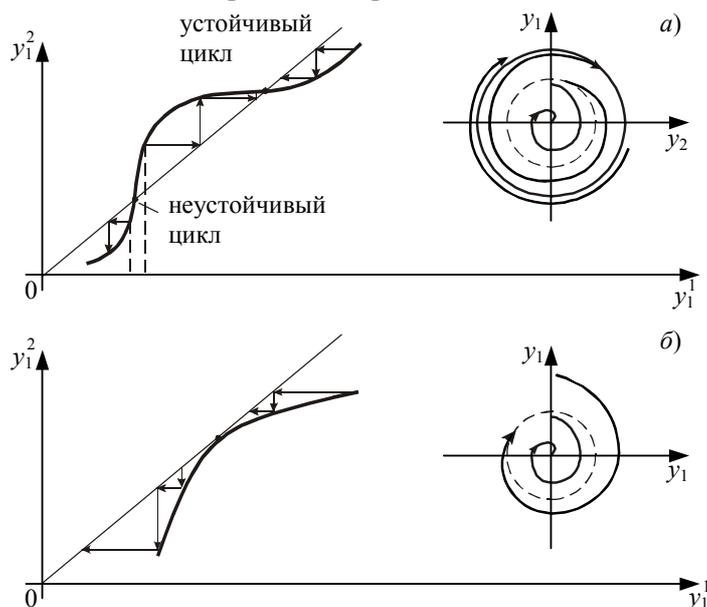
**Рис. 13.5** Варианты точечного преобразования:
