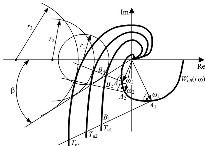
РИС. 9.5 К ОПРЕДЕЛЕНИЮ КОЭФФИЦИЕНТОВ ПЕРЕДАЧИ ПИ-регулятора для различных  $T_{\text{ил}}$
