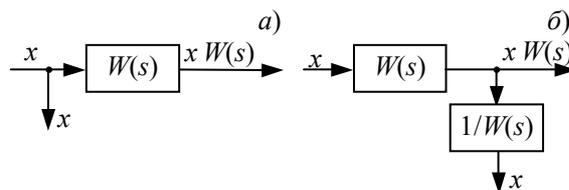
**Рис. 5.40 Перенос узла через звено:**
