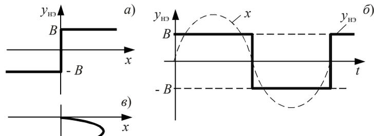
**Рис. 10.6** Двухпозиционное реле:
