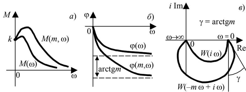
РИС. 7.13 РАСШИРЕННЫЕ ЧАСТОТНЫЕ ХАРАКТЕРИСТИКИ:
