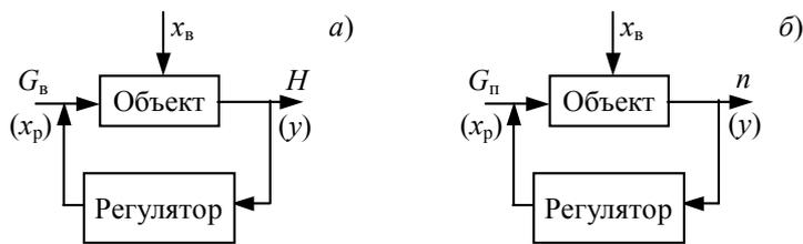
**Рис. 1.5 Структурные схемы систем регулирования:**
