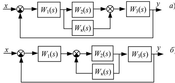
Рис. 7.22 Структурная схема параллельной коррекции
