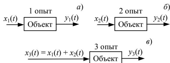
**Рис. 3.5** Иллюстрация эксперимента по проверке объекта
