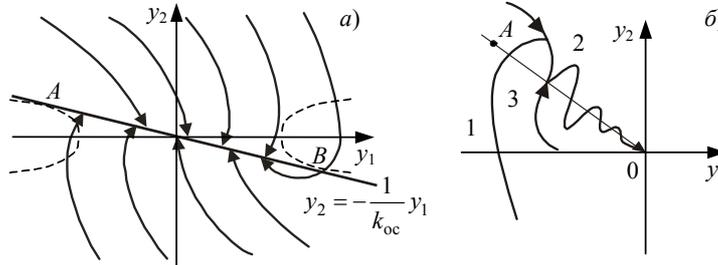
**Рис. 11.14 Построение фазового портрета методом шивания:**
