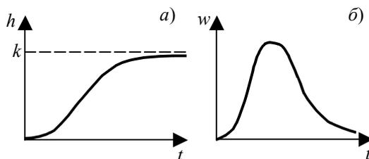
**Рис. 5.22** Переходные характеристики апериодического звена второго порядка:
