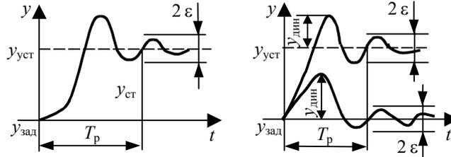
РИС. 8.1 СТАТИЧЕСКАЯ ОШИБКА РЕГУЛИРОВАНИЯ
