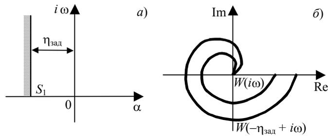
Рис. 7.11 Расширенная частотная характеристика по степени устойчивости:
