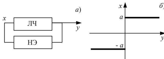
**Рис. 11.12 Релейная система:**
