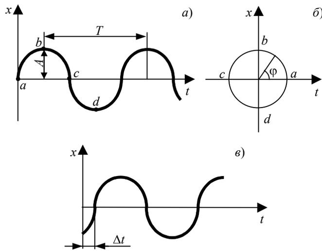
**Рис. 2.8 Гармонический сигнал:**
