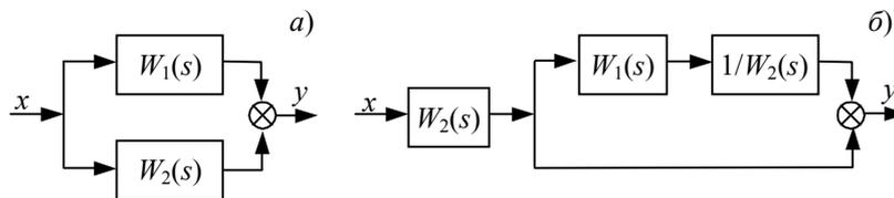
**Рис. 5.44 Вынесение элемента из прямой связи:**
