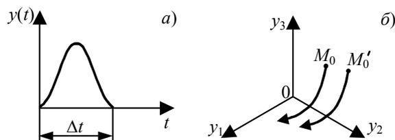
**Рис. 6.13 Действие импульсного возмущения:**
