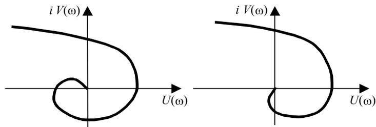
**Рис. 7.20** Годографы Михайлова с целью определения структурной устойчивости системы, состоящей из устойчивых инерционных, колебательных звеньев:
