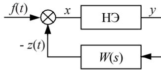
**Рис. 12.7** Нелинейная система с исчезающим воздействием
