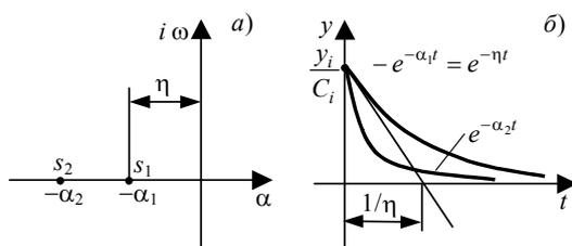
РИС. 8.5 ОПРЕДЕЛЕНИЕ КАЧЕСТВА МОНОТОННЫХ ПЕРЕХОДНЫХ ПРОЦЕССОВ ПО СТЕПЕНИ УСТОЙЧИВОСТИ:
