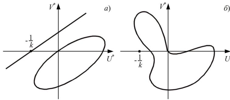
**Рис. 12.9** Геометрическая трактовка абсолютной устойчивости системы: *a* – устойчивая систем; *б* – неустойчивая
