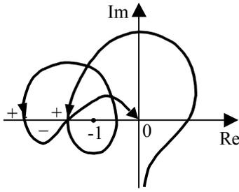
**Рис. 6.29** АФХ разомкнутой системы при  $m = 2$
