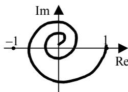
**Рис. 6.34** АФХ разомкнутой системы к примеру 6.4
