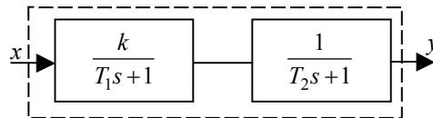
**Рис. 5.20 Структурная схема аperiodического звена второго порядка**
