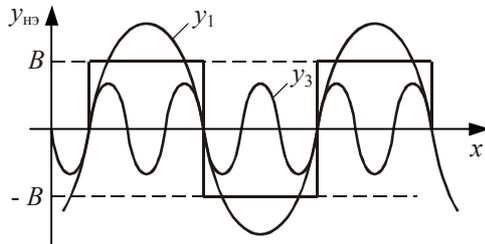
**Рис. 10.11** Гармоническая линеаризация
