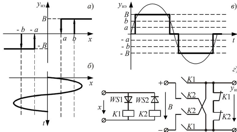
**Рис. 10.9** Трехпозиционное реле с зоной нечувствительности:
