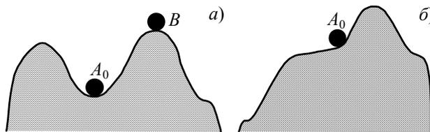
**Рис. 6.3 Полуустойчивые состояния равновесия**
