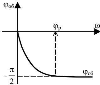
РИС. 7.4 ОПРЕДЕЛЕНИЕ ЧАСТОТЫ ГРАНИЦЫ УСТОЙЧИВОСТИ СИСТЕМЫ С И-РЕГУЛЯТОРОМ
