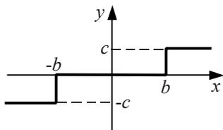
**Рис. 13.10 Статическая характеристика трехпозиционного**
